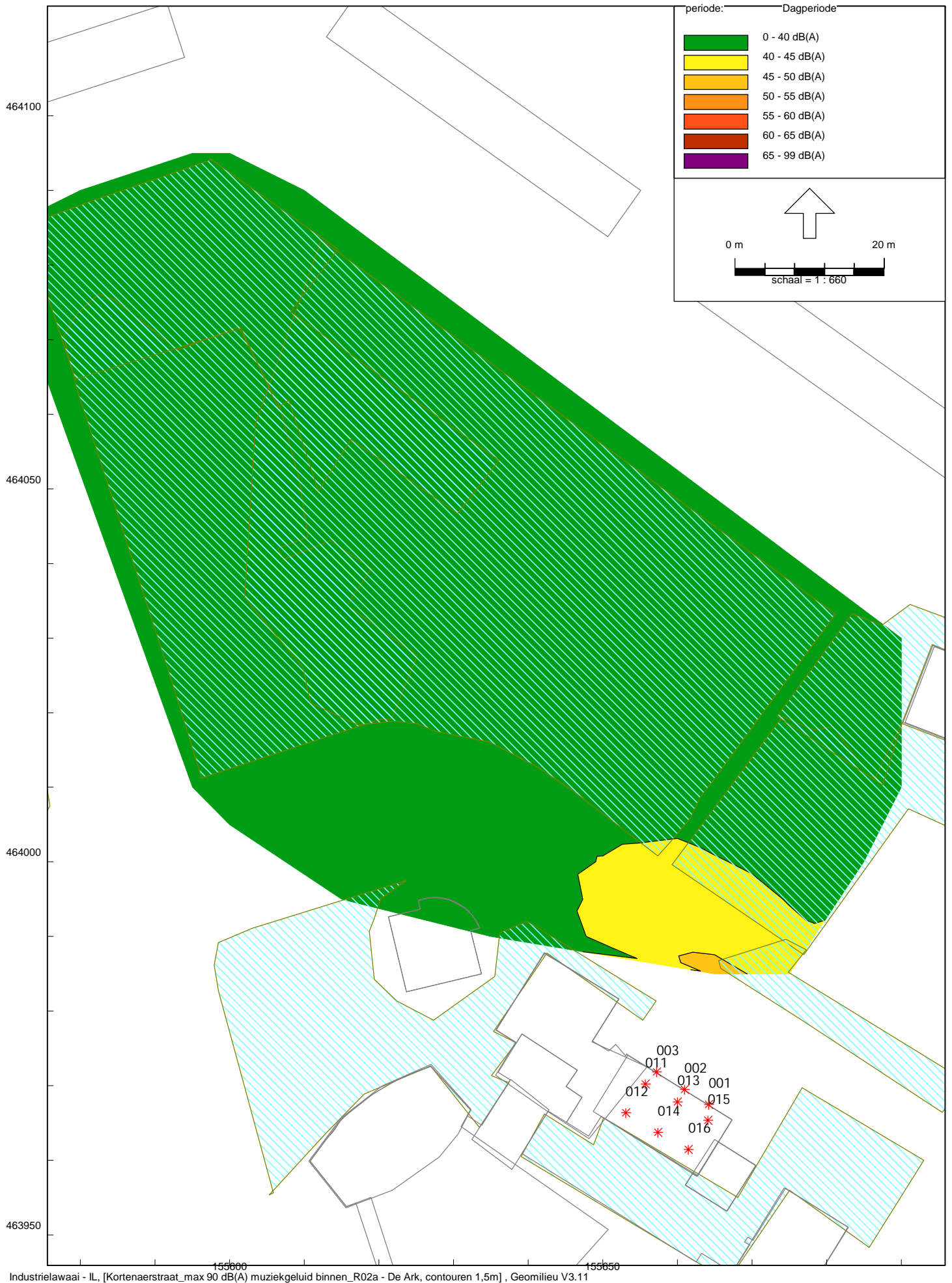
Geluidcontouren op 1,5 m hoogte (zonder strafcorrectie 10 dB)
