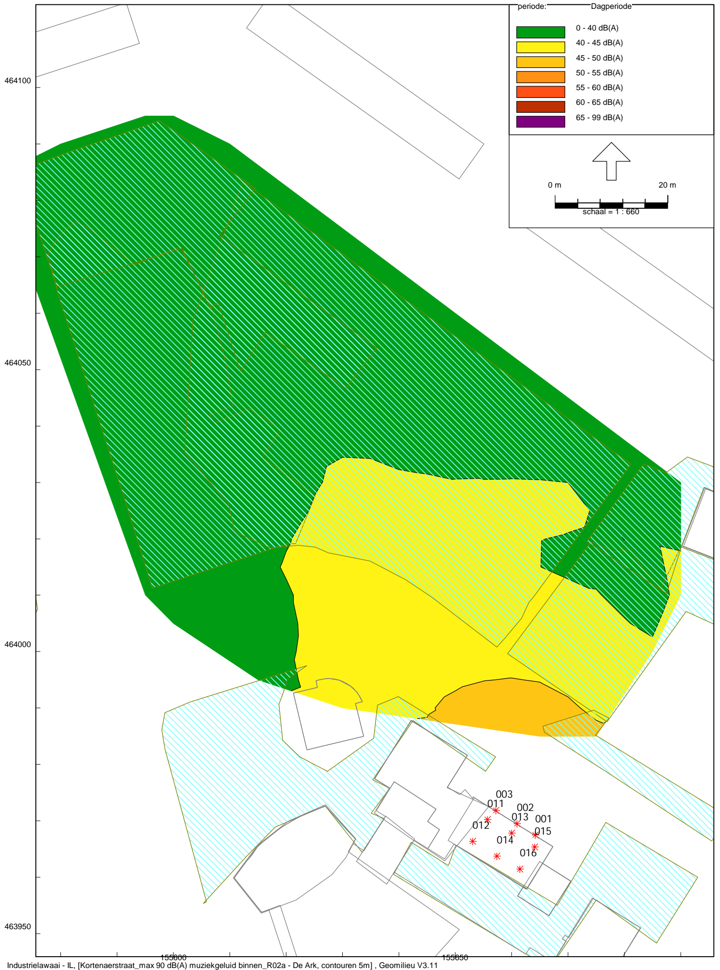
Geluidcontouren op 5 m hoogte (zonder strafcorrectie 10 dB)
