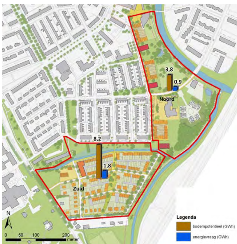
Figuur 5.7 energieaanbod en -vraag voor Randenbroek Zuid
