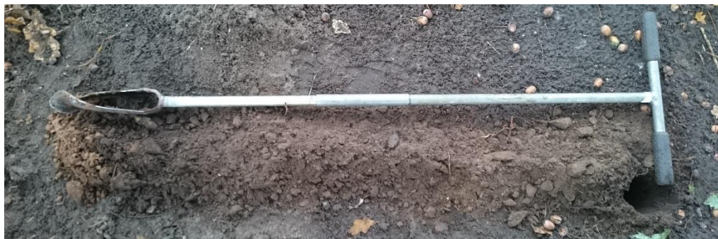
Boorprofiel met een vrij dunne humusrijke toplaag (rechts) en daaronder een lichtbruin pakket met een dikte van ca. 80 cm van fijn tot zeer fijn zand. In deze laag zijn tussen 20 en 30 cm en tussen 80 en 90 cm diep wortels in de boring aangetroffen.
