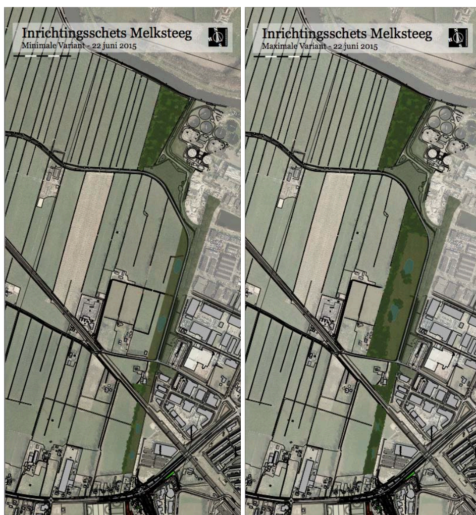
Figuur 2.3 Inrichtingsschets natuurgebied langs de A.P. Hilhorstweg De linker afbeelding toont de gewenste minimale variant, waarbij over de gehele lengte een brede natuurvriendelijke oever wordt aangelegd. Rechts een maximale invulling, waarbij naast de oever ook is voorzien in ontwikkeling van een bloemrijk hooiland. Het bos in het noorden wordt aangelegd in het kader van de compensatie voor de Boswet (bron: H+N+S Landschapsarchitecten d.d. 22 juni 2015).
