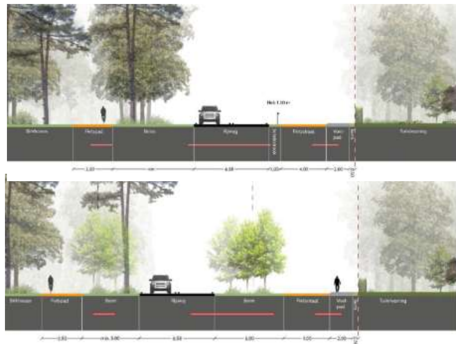
Figuur 7.18: Verschuiving wegprofiel BW-laan Noord met toevoeging beplanting (Variant 7b (2015)): verminderde barrière werking.
