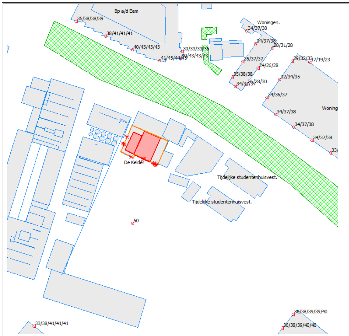
Figuur 4: Berekend met het housemuziekspectrum: Langtijdgemiddelde geluidniveau L_{A,LT} ter plaatse van de gevels van de nieuwe woningen (op 1,5m/ 5m/ 8m/ 11m hoogte) bij gebruik van de zaal van het podium.
