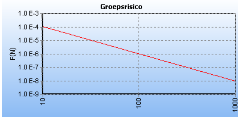
5.3 Figuur: FN curve voor W-520-05 van N.V. Nederlandse Gasunie voor de kilometer tussen stationing 2420.00 en stationing 3420.00
