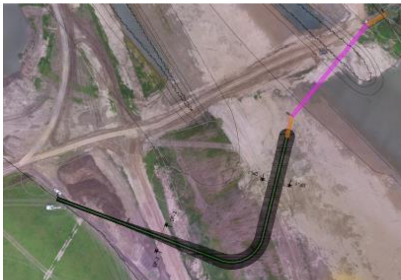
Figuur 2.2. Ligging van de verbinding, met groen het grondlichaam, oranje de vaste steigerdelen en roze de drijvende verbinding
