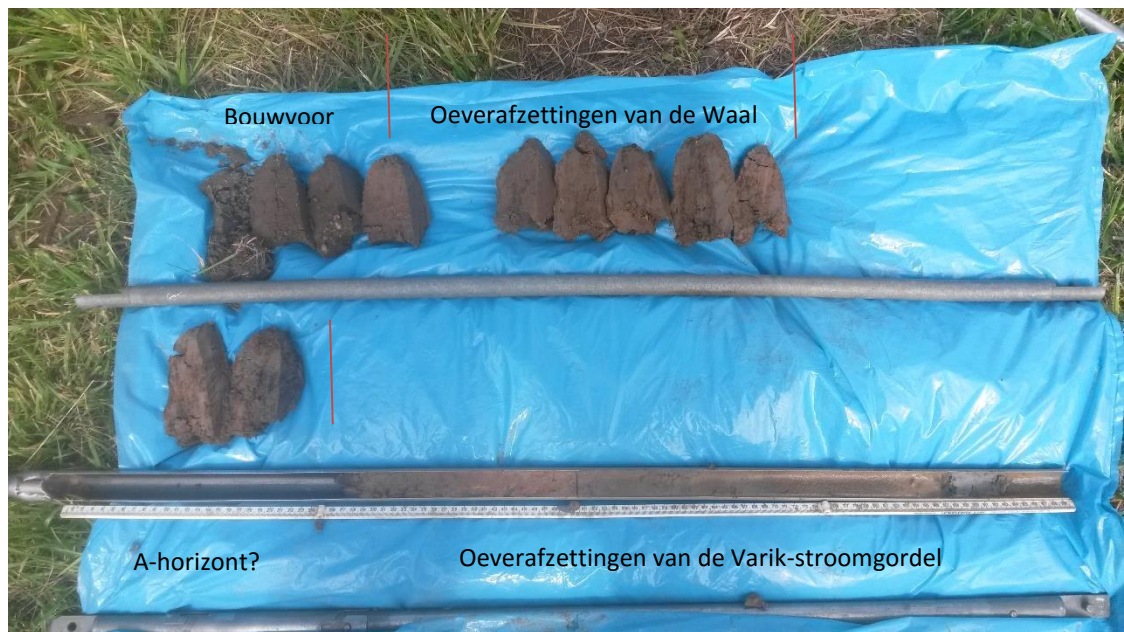
Figuur 8 Oeverafzettingen van de Waal en de top van de afzettingen van de Varik-stroomgordel in boring 2.
