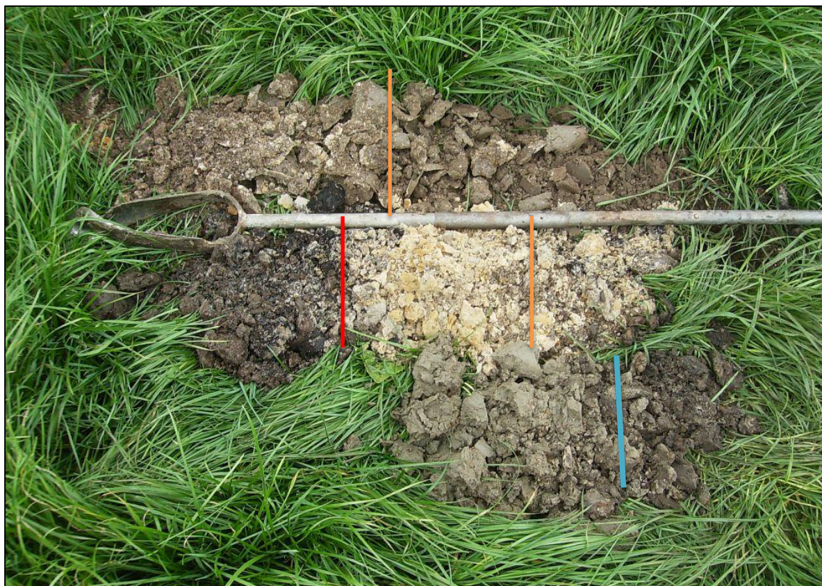
Afbeelding 3. Beeld van boring 5 met tussen de oranje lijnen de gediëpploegde bodem, tot de rode lijn het onderliggende zand, tot de blauwe lijn het veen en links daarvan de zandondergrond
