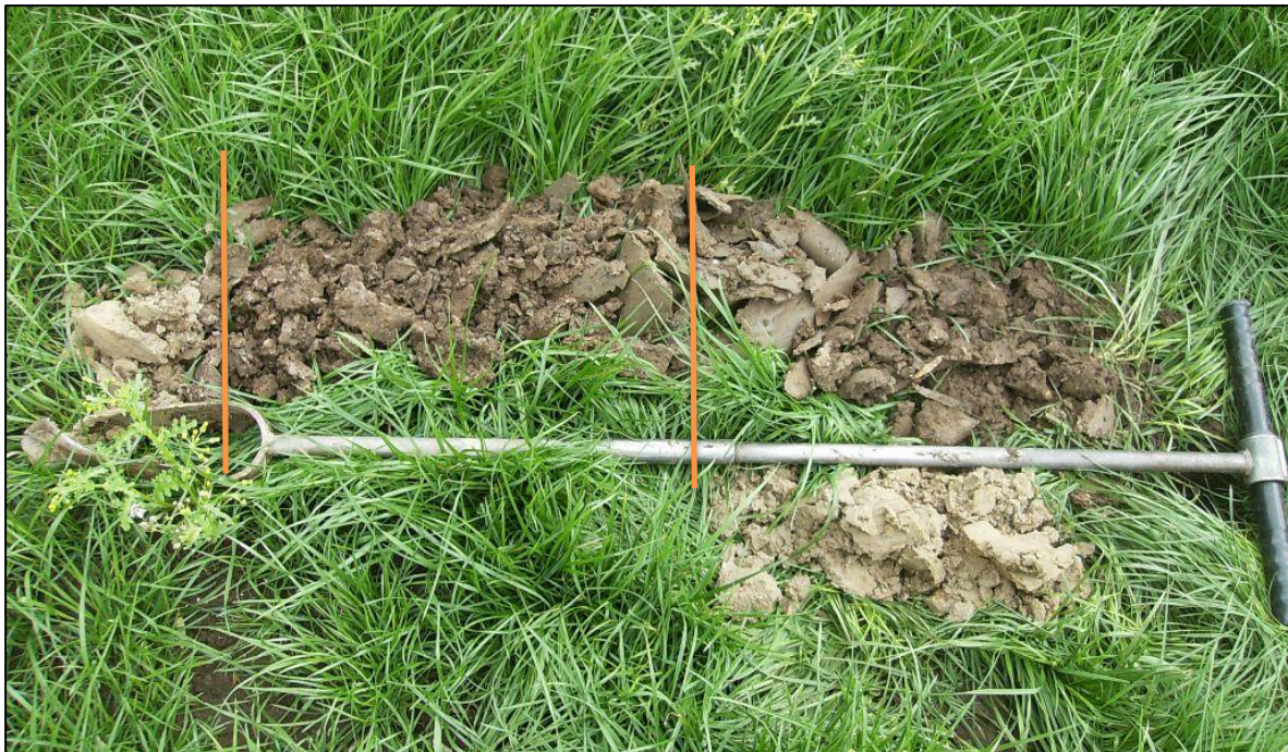
Afbeelding 2. Beeld van boring 1 met tussen de lijnen de gediëpploegde bodem, rechts de bouwvoor en daaronder de dekzandondergrond
