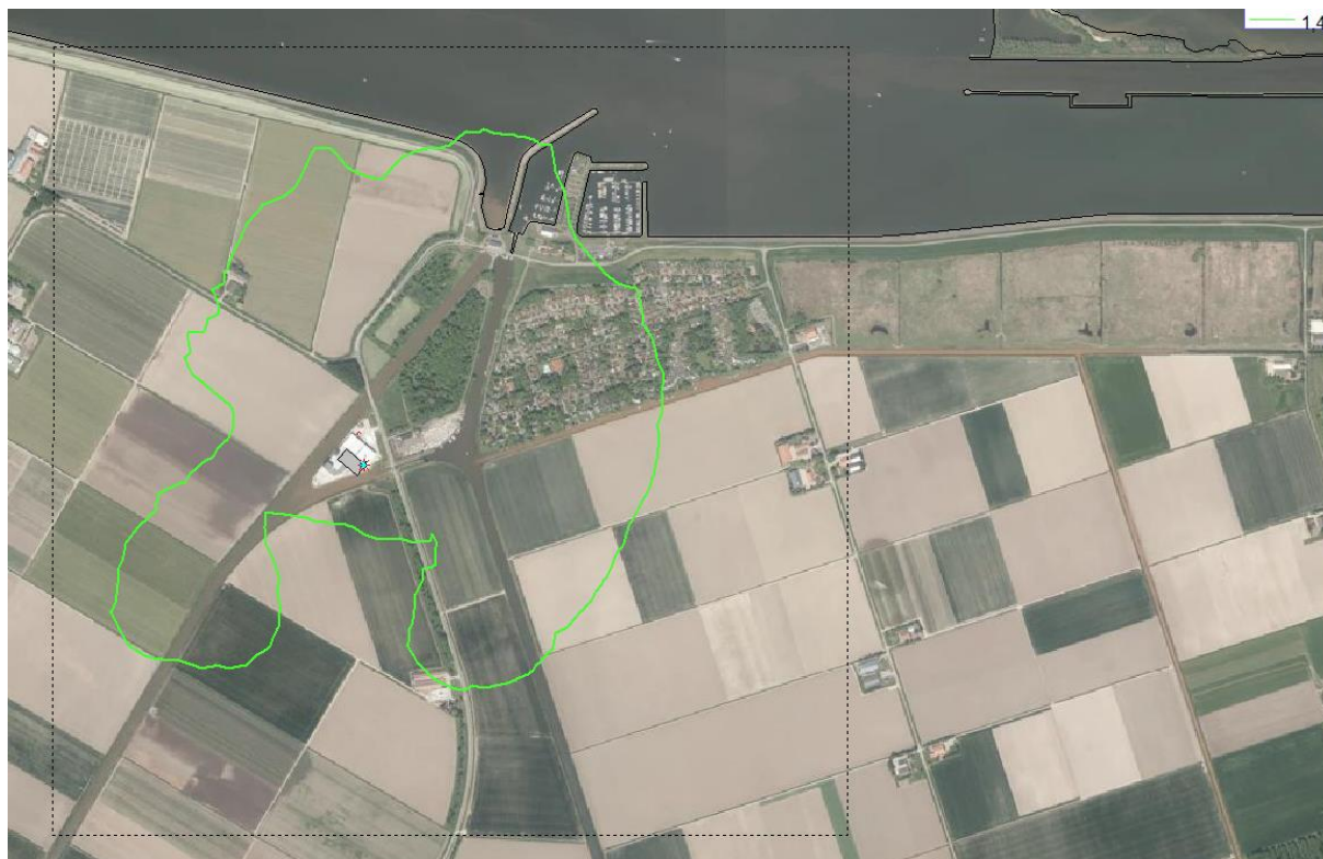
Figuur 4.1 Geurcontour van Komeco van 1,4 \text{ ouE/m}^3 als 99,5 percentiel in de huidige situatie met een schoorsteenhoogte van 52m
