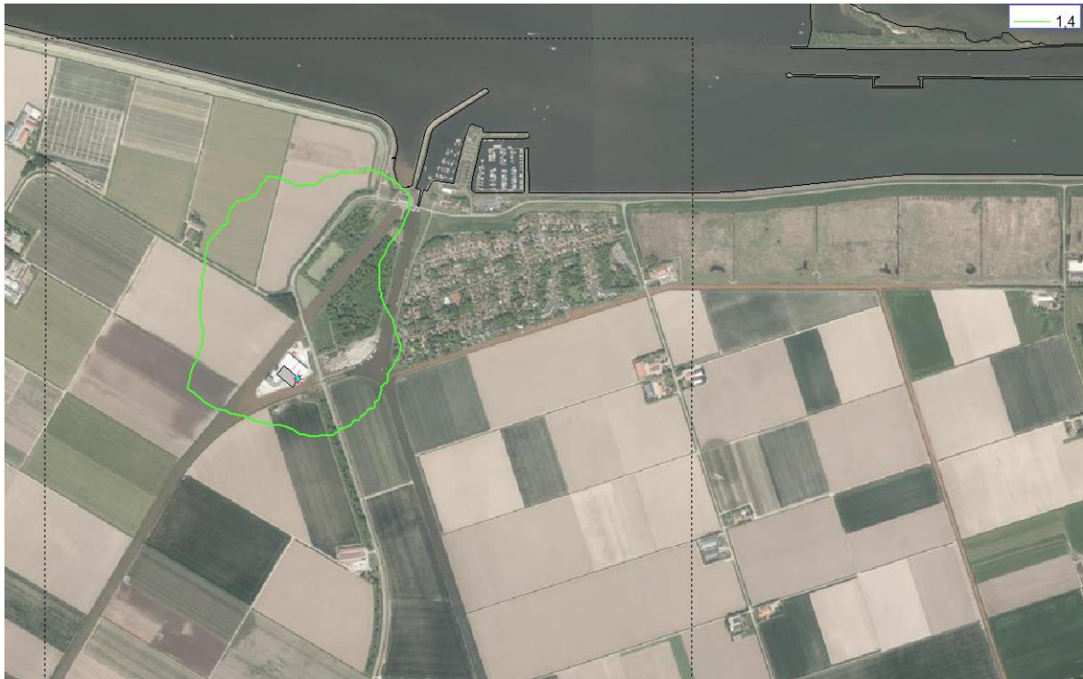
Figuur 4.2 Geurcontour van Komeco van 1,4 ouE/m 3 als 99,5 percentiel in de situatie met een schoorsteenhoogte van Komeco van 60m
