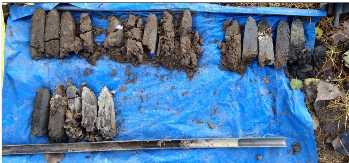
Boring 1: 0-250 cm –Mv. Bovenste rij boorkernen 0-150 cm –Mv, onderste rij boorkernen 150-200 cm –Mv, guts 200-250 cm –Mv.
