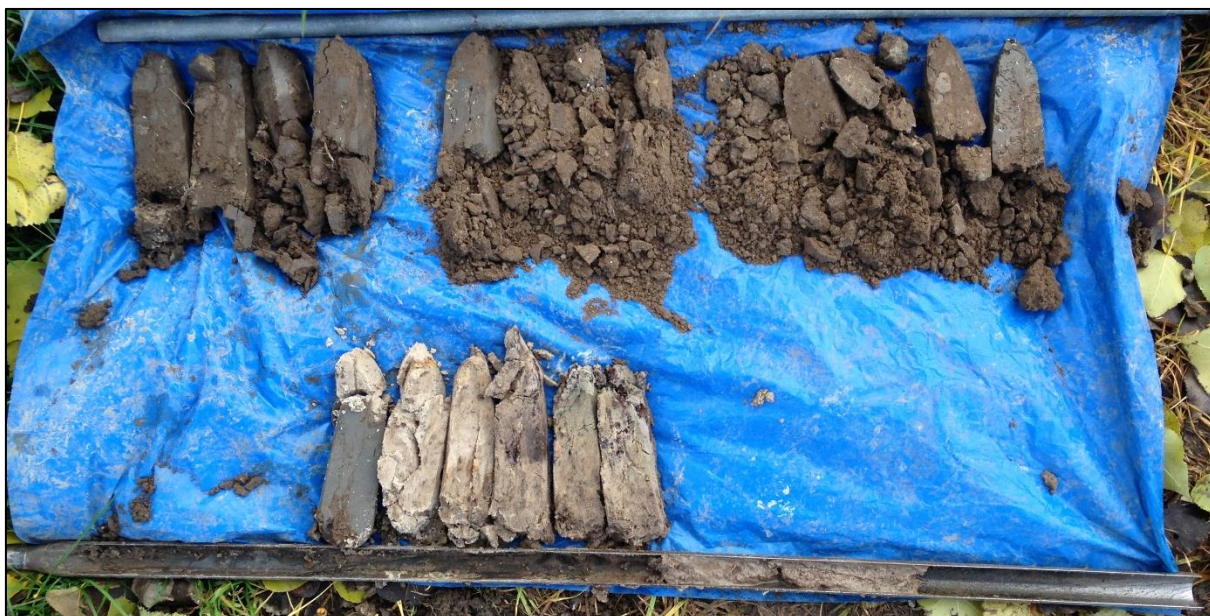
Boring 3: 0-250 cm –Mv. Bovenste rij boorkernen 0-150 cm –Mv, onderste rij boorkernen 150-200 cm –Mv, guts 200-250 cm –Mv.
