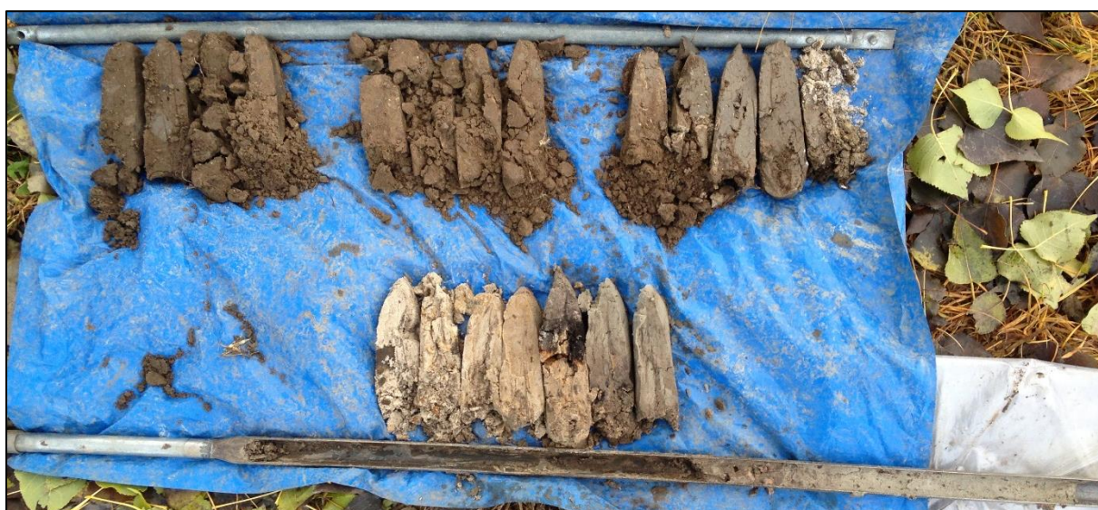
Boring 2: 0-250 cm –Mv. Bovenste rij boorkernen 0-150 cm –Mv, onderste rij boorkernen 150-200 cm –Mv, guts 200-250 cm –Mv.
