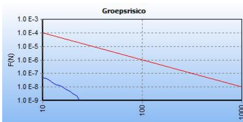
Afbeelding 10 fN-curve buisleiding N-570-20-deel-1, huidige situatie
