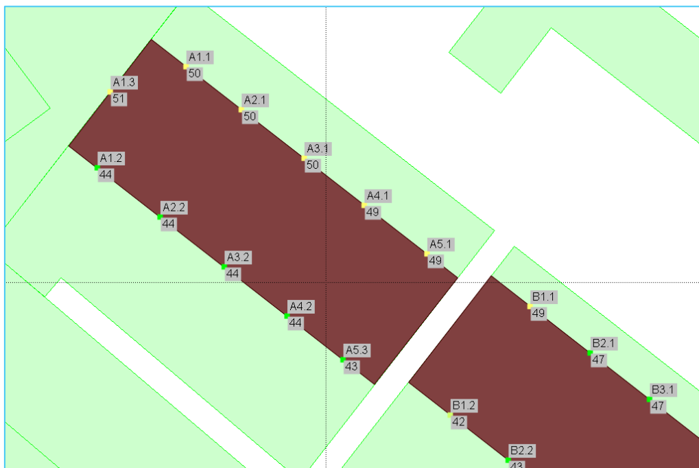
Figuur 11 Geluidbelasting a.g.v. de Harderwijkerweg (incl. aftrek art. 110g Wgh). De geluidbelastingen op de achtergevels is minder dan 48 dB en dus geluidluw te noemen.
