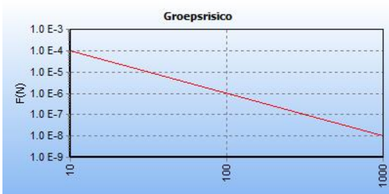
5.2 Figuur 5.2 FN curve voor 8417_leiding-N-570-20-deel-1 van N.V. Nederlandse Gasunie voor de kilometer tussen stationing 1520.00 en stationing 2520.00
