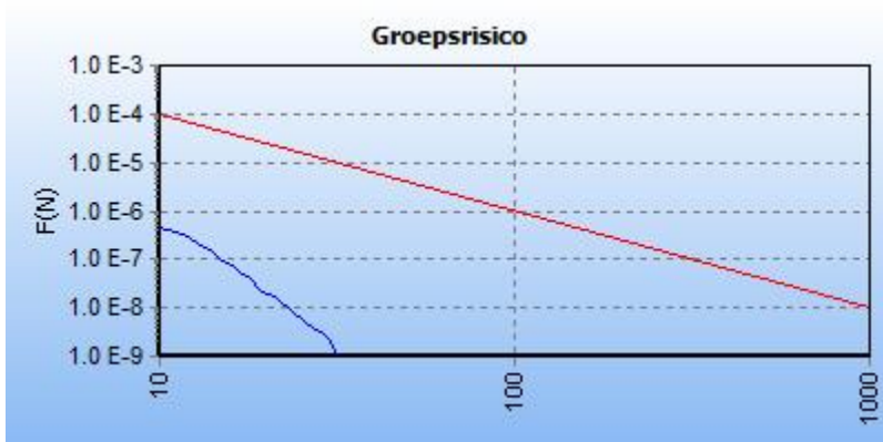
5.2 Figuur 5.2 FN curve voor 8417_leiding-N-570-20-deel-1 van N.V. Nederlandse Gasunie voor de kilometer tussen stationing 1520.00 en stationing 2520.00
