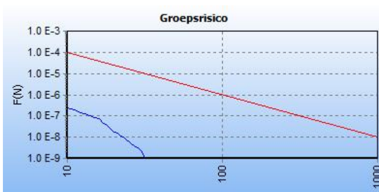
Afbeelding 6 fN-curve buisleiding A-510-deel-1, huidige situatie
