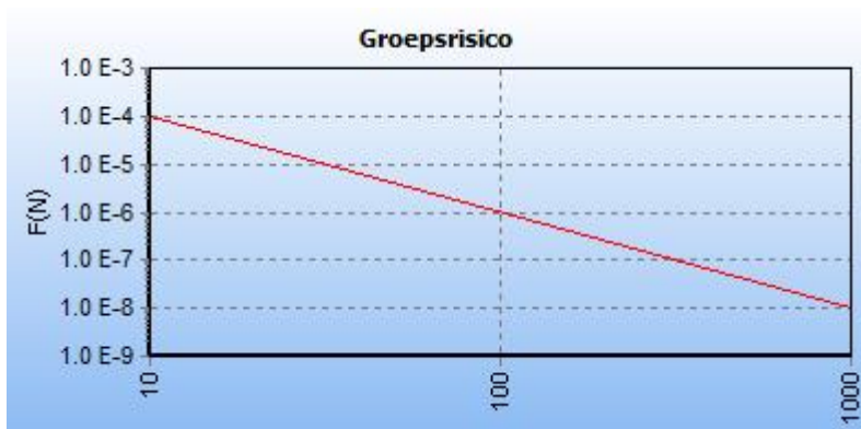
Afbeelding 11 fN-curve buisleiding N-570-20-deel-1, huidige situatie
