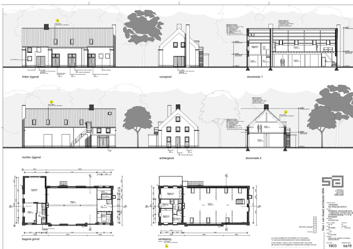
Afbeelding 5.3 Bouwtekeningen van indelingen en gevelaanzichten en doorsneden van het gebouw van het Koetshuis behorende bij het Landhuis De Grote Bunte
