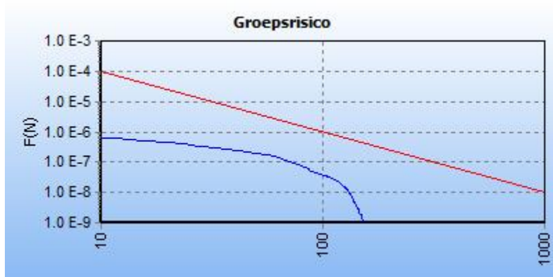
Figuur 2.13: fN-curve buisleiding N-570-20-deel-1, na planrealisatie
