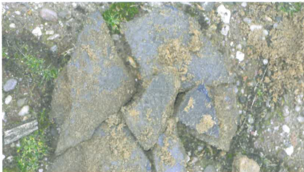
Foto 8: asbest verdacht materiaal uit inspectiegat G12
