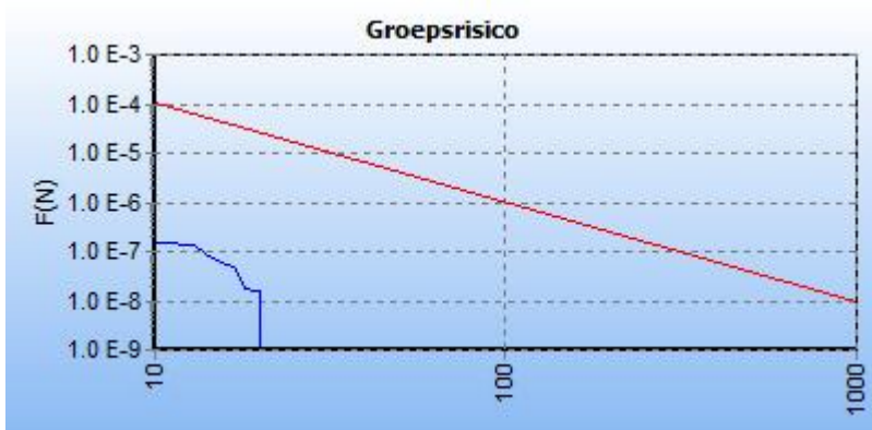
5.2 Figuur 5.2 FN curve voor A-505 van N.V. Nederlandse Gasunie voor de kilometer tussen stationing 40300.00 en stationing 41300.00
