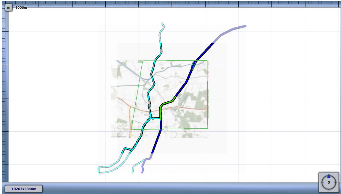
Figuur 4.3 Kilometer leiding behorende bij de maximale overschrijding van de FN-curve voor A-506 van N.V. Nederlandse Gasunie
