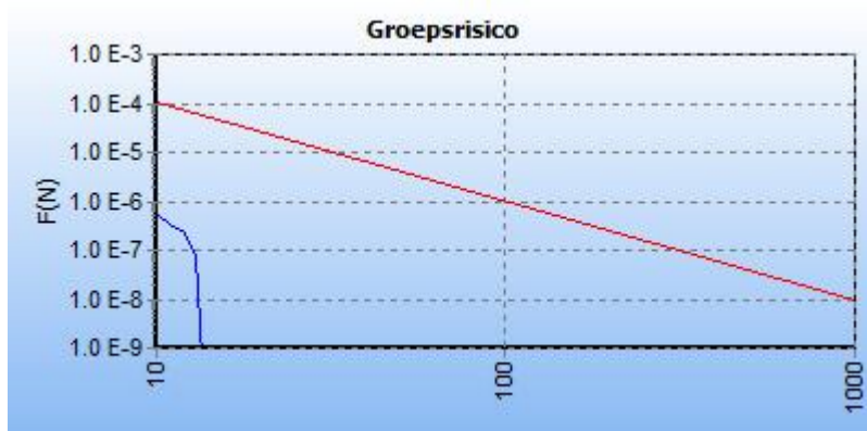
5.4 Figuur 5.7 FN curve voor A-608 van N.V. Nederlandse Gasunie voor de kilometer tussen stationing 4880.00 en stationing 5880.00
