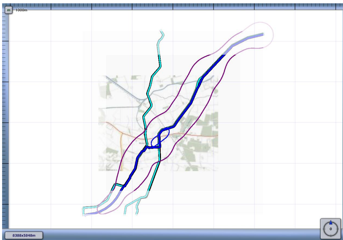
3.1 Figuur 3.1 Plaatsgebonden risico voor A-662 van N.V. Nederlandse Gasunie
