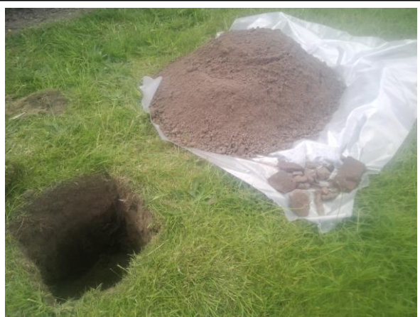
Foto 10. Asbestinspectiegat en opgegraven materiaal gat B9
