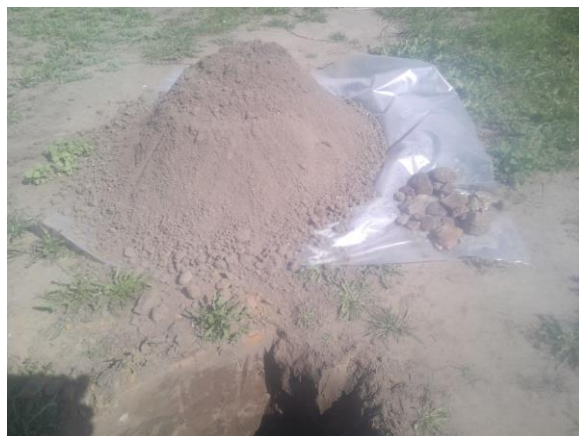
Foto 2. Asbestinspectiegat en opgegraven materiaal gat B1
