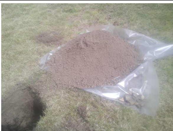
Foto 9. Asbestinspectiegat en opgegraven materiaal gat B8
