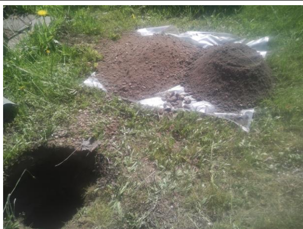
Foto 3. Asbestinspectiegat en opgegraven materiaal gat B2
