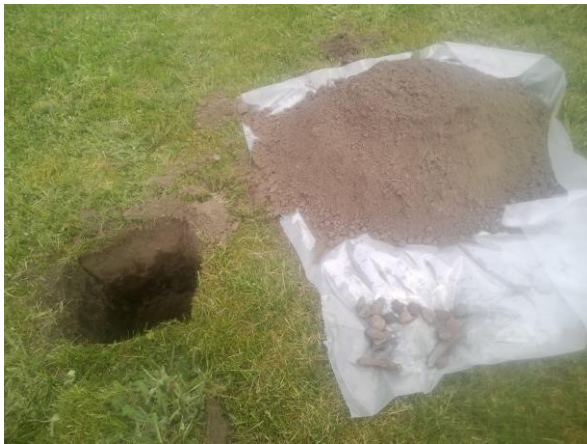
Foto 9. Asbestinspectiegat en opgegraven materiaal gat B8
