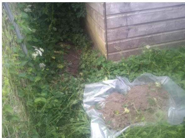
Foto 1. Asbestinspectiegat en opgegraven materiaal gat A1
