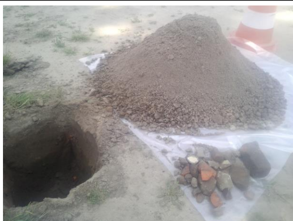
Foto 1. Asbestinspectiegat en opgegraven materiaal gat A1
