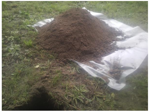
Foto 10. Asbestinspectiegat en opgegraven materiaal gat B9
