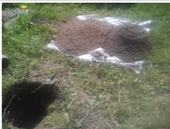
Foto 3. Asbestinspectiegat en opgegraven materiaal gat B2
