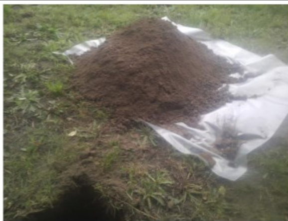
Foto 10. Asbestinspectiegat en opgegraven materiaal gat B9
