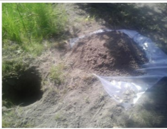
Foto 4. Asbestinspectiegat en opgegraven materiaal gat B3
