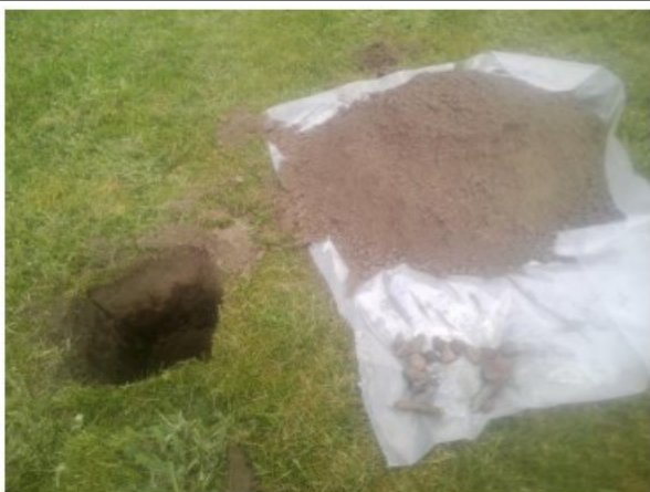
Foto 9. Asbestinspectiegat en opgegraven materiaal gat B8
