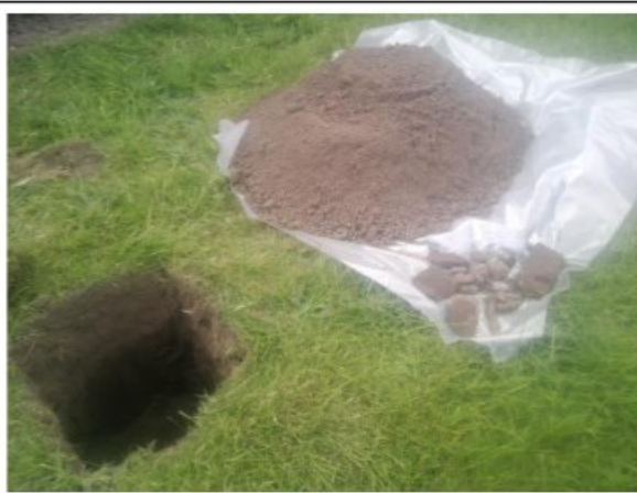
Foto 10. Asbestinspectiegat en opgegraven materiaal gat B9
