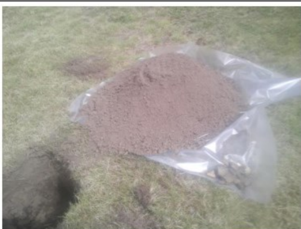
Foto 9. Asbestinspectiegat en opgegraven materiaal gat B8
