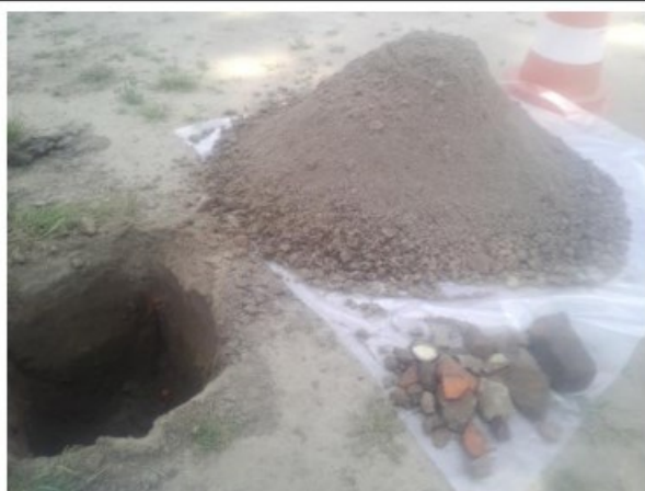
Foto 1. Asbestinspectiegat en opgegraven materiaal gat A1
