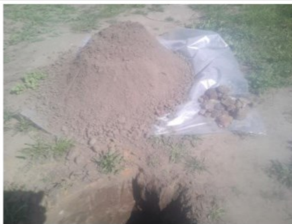
Foto 2. Asbestinspectiegat en opgegraven materiaal gat B1
