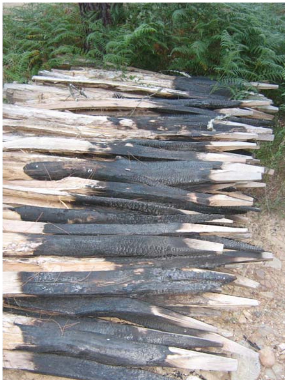
Afbeelding 33: aangekoolde heiningpalen, klaar voor gebruik. Merk op dat de punten zelf niet zijn aangekoold. Hierdoor blijft de punt tijdens het ingraven stevig genoeg om de paal in de grond te drijven. (Malbosc, Ardèche, Frankrijk 2008)
