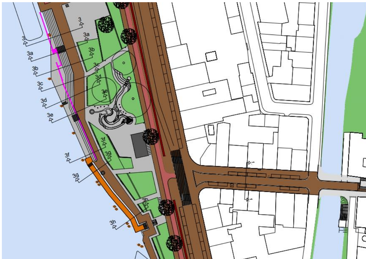
Figuur 4 Ontwerpaanpassingen met in de rivier vooruitgeschoven uiteinde van de trappartij (profielen 3b t/m 3f) uitlopend in een loopbrug op 5 m+NAP (profielen 3g en 3h)
