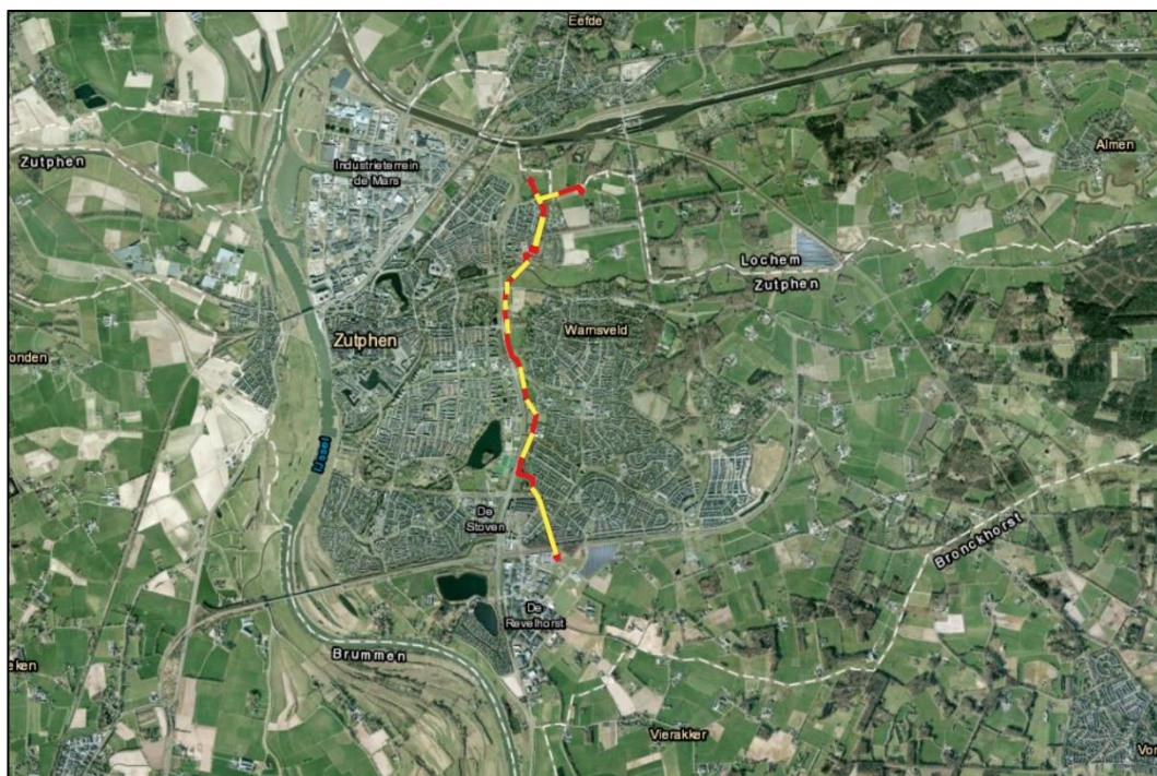
Figuur 4.1. Ligging van het tracé (rood is open ontgraving, geel is gestuurde boring) (bron achtergrond: Esri).
