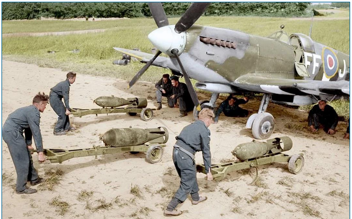
Figuur 2. Een Spitfire jachtbommenwerper wordt geladen met twee 250 lb. GP onder de vleugels en een 500 lb. MC bom onder de romp in 1944. (bron: Imperial War Museum).
