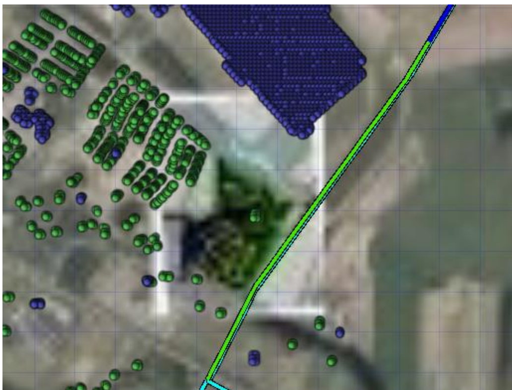
Afbeelding 4 Kilometer leiding met hoogste overschrijdingsfactor (in groen weergegeven) vóór planrealisatie
