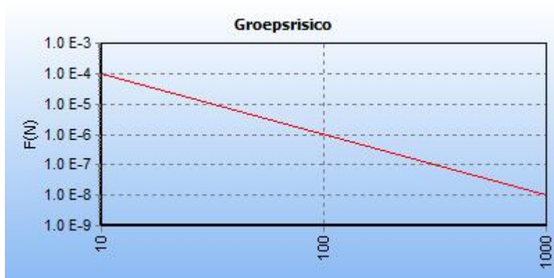
5.5 Figuur 5.5 FN curve voor 7100_leiding-N-566-11-deel-1 van N.V. Nederlandse Gasunie voor de kilometer tussen stationing 1790.00 en stationing 2790.00
