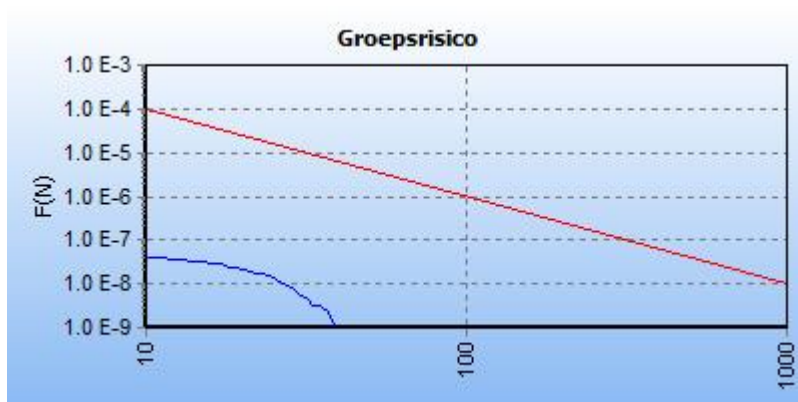
5.5 Figuur 5.5 FN curve voor 7100_leiding-N-566-11-deel-1 van N.V. Nederlandse Gasunie voor de kilometer tussen stationing 1790.00 en stationing 2790.00
