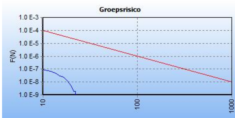
5.4 Figuur 5.4 FN curve voor 7100_leiding-N-566-10-deel-1 van N.V. Nederlandse Gasunie voor de kilometer tussen stationing 0.00 en stationing 1000.00
