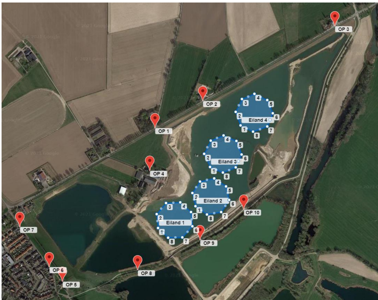
Figuur 4.1: Ingetekende zonne-eilanden (transparant blauwe vlakken) met daarbij de observatiepunten waarvoor de reflectie berekend wordt.
