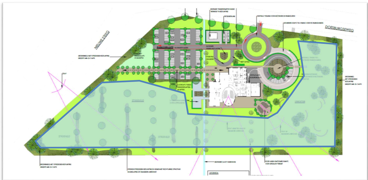
Op deze wijze wordt het hemelwater indirect in de omgeving geïnfiltreerd. Er is geen sprake van directe lozing op een waterschapsloot. Dit zal worden geborgd in het uit te werken infiltratieplan. Ook bui T100 kan in het plangebied worden geborgen zonder overlast en schade. De terreinverharding zal bovengronds afwateren op de tuin en de weiden.
