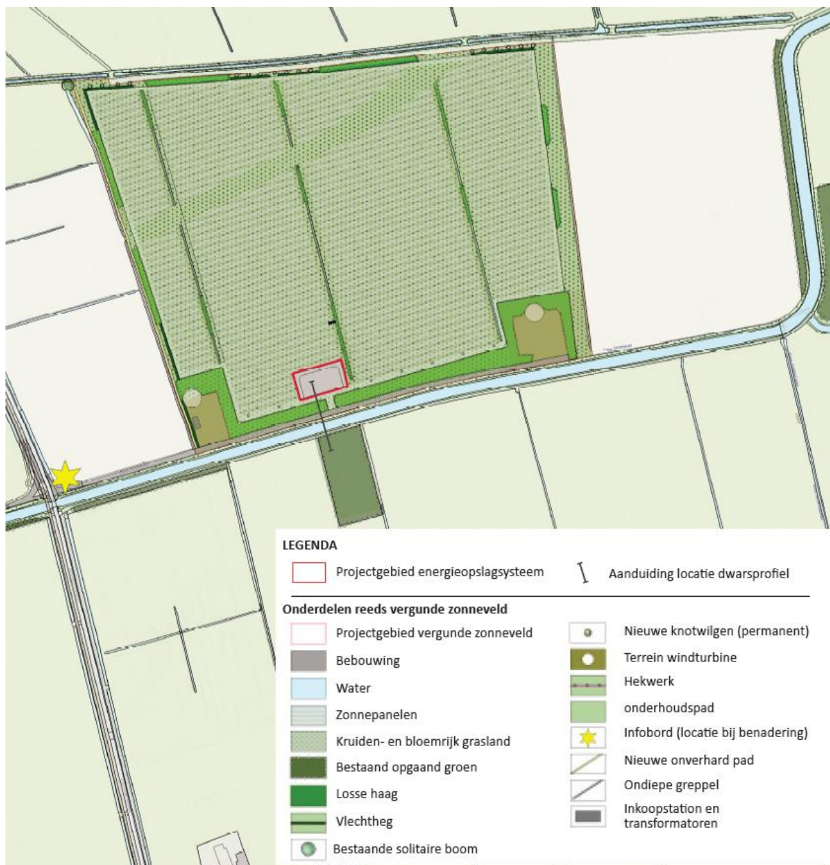
Figuur 5: Weergave overzichtstekening inpassing energieopslagsysteem binnen Zonnepark Bijvanck.
