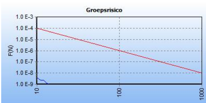
Figuur 51: De fN-curve voor deze kilometer leiding (leiding N-566-02 in de toekomstige situatie).
