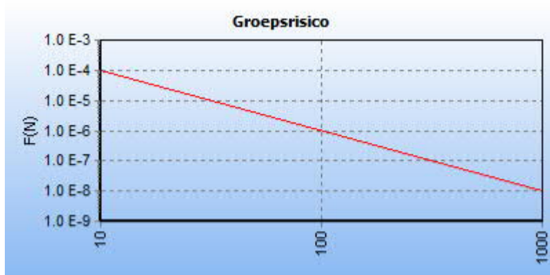
5.4 Figuur 5.4 FN curve voor 6067_leiding-N-566-02-deel-1 van N.V. Nederlandse Gasunie voor de kilometer tussen stationing 800.00 en stationing 1800.00
