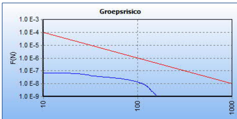
Afbeelding 10 fN-curve buisleiding A-512, ter hoogte van het plangebied – huidige situatie
