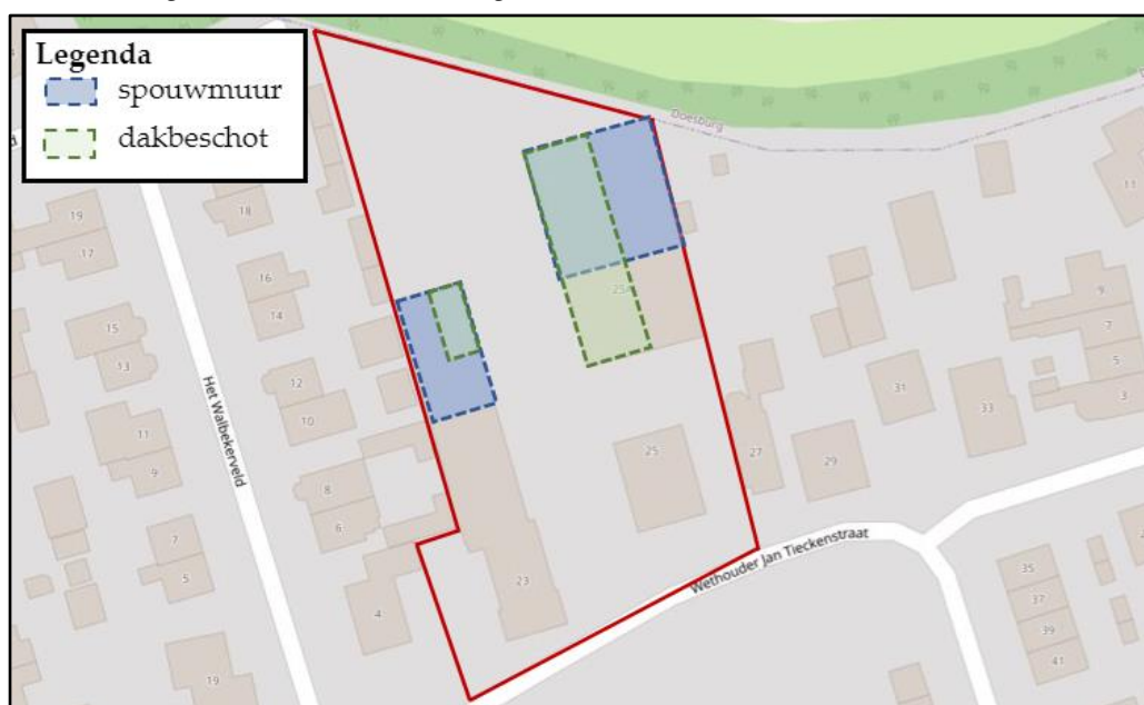
Figuur 2 Grafische weergave van constructies met spouwmuur (blauw omkaderd) en dakbeschot (groen omkaderd) (bron kaartmateriaal: arcgis.com).
