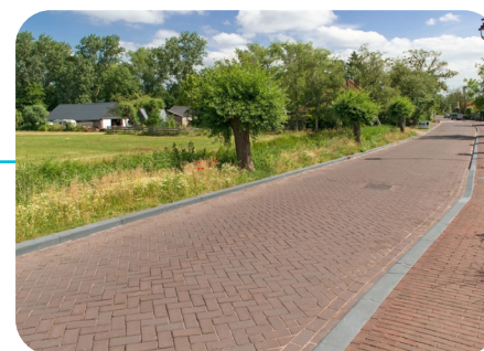
De rijbaan en het trottoir onderscheiden zich in kleurnuance en legverband
