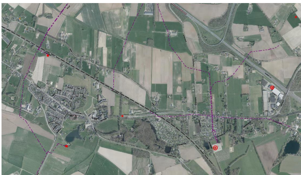
Figuur 2.18 Gasleidingen en veiligheidscontour gascompressiestation Zweekhorst
