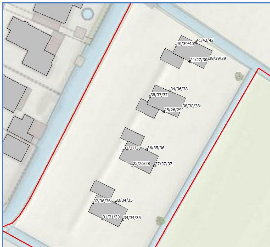
Afbeelding 6.2 Geluid L_{den} Gemeentewegen Berekend geluid op een hoogte van 2,0 ; 5,0 ; 8,0 en 11,0 meter
