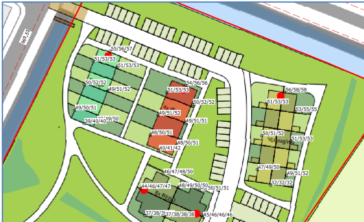
Afbeelding 7. Geluid L_{den} Gemeentewegen Conceptontwerp en geluidluwe gevel relevante woningen Berekend geluid op een hoogte van 2,0 ; 5,0 ; 8,0 en 11,0 meter
