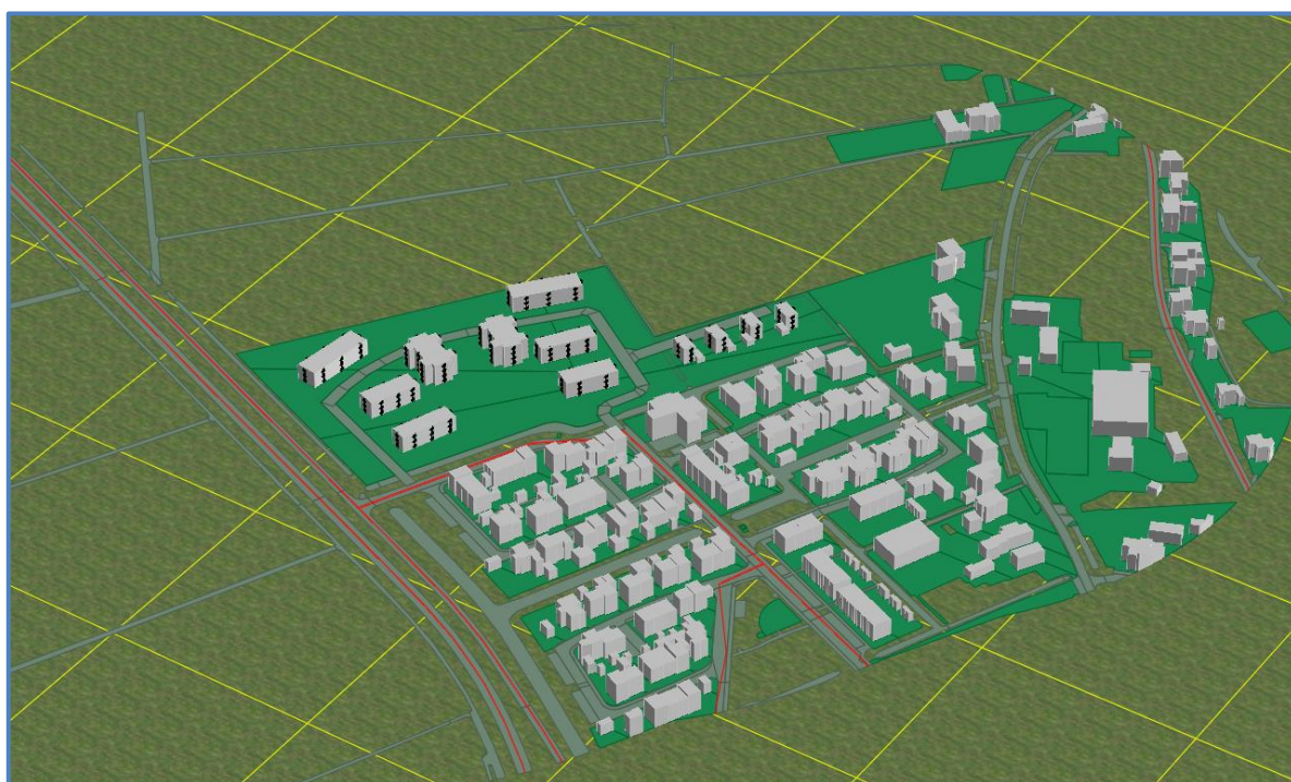
Afbeelding 5. Rekenmodel wegverkeerslawaaï, 3d-weergave
