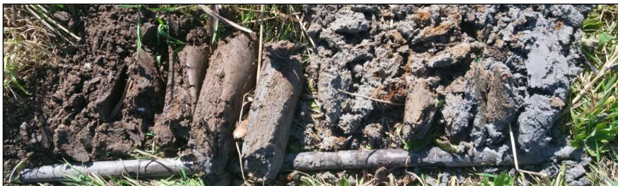
Figuur 9: de bovenste meter van de boorkern van boring 3 met de in de ondergrond aanwezige zandlaag.
