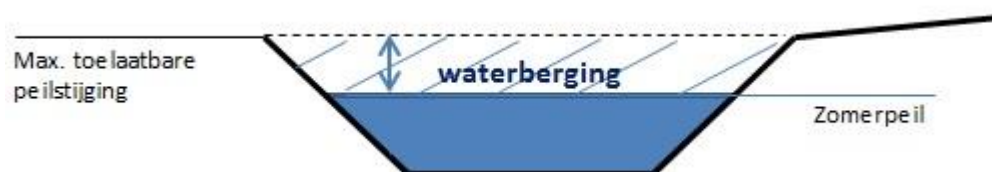
Figuur 3-1: voorbeeld waterberging in oppervlaktewater
