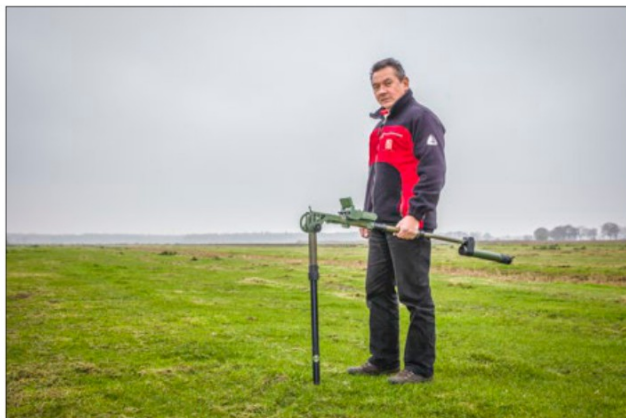
Figuur 7. Passieve realtime oppervlakedetectie met een Vallon VX1 Magnetometer en een staafdiagram waarop het maximale detectiebereik (m 1 – maaiveld) per kaliber.
