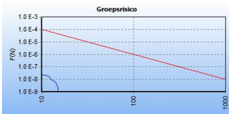
5.1 Figuur 5.1 FN curve voor 5780_leiding-A-618-deel-1 van N.V. Nederlandse Gasunie voor de kilometer tussen stationing 1670.00 en stationing 2670.00
