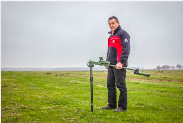
Figuur 7. Passieve realtime oppervlakedetectie met een Vallon VX1 Magnetometer en een staafdiagram waarop het maximale detectiebereik (m² – maaiveld) per kaliber.
