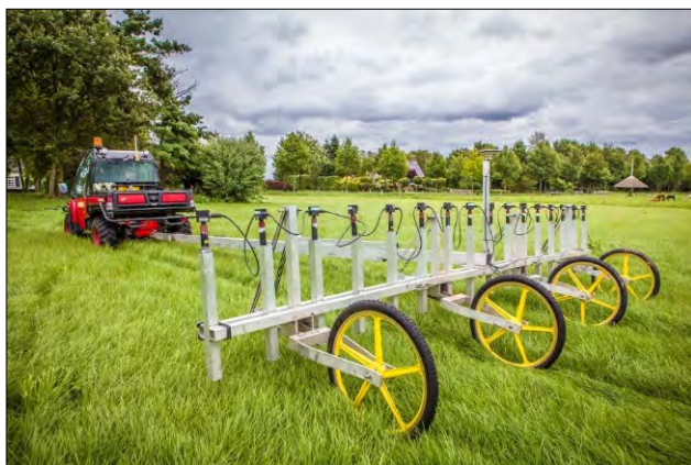
Figuur 3. Passieve non realtime oppervlakedetectie met het Vallon Multisondesysteem VXV16 en een staafdiagram waarop het maximale detectiebereik (m² – maaiveld) per kaliber.
