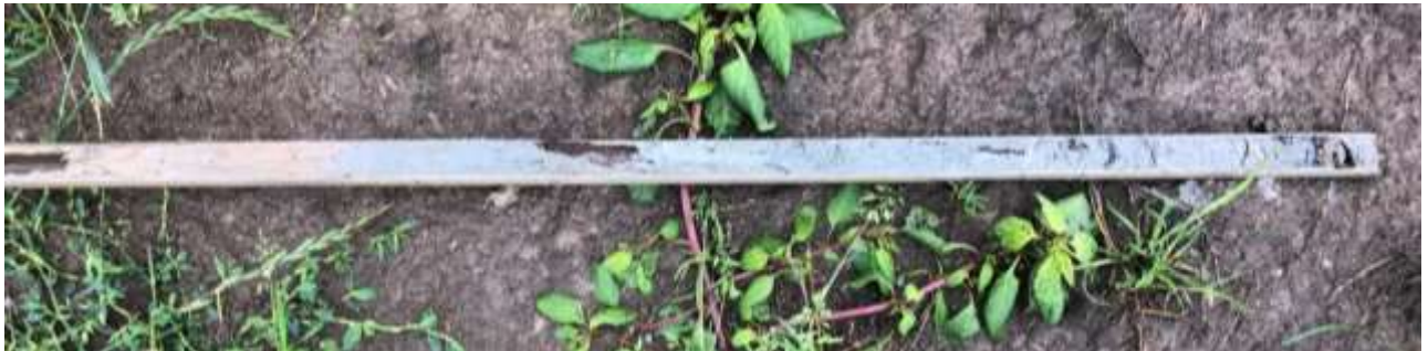
Figuur 19: Foto van boring 13 met links geoxideerde komklei, in het midden sterk zandige, ongeoxideerde klei die overgaat in (matig) grof zand (geheel rechts)
