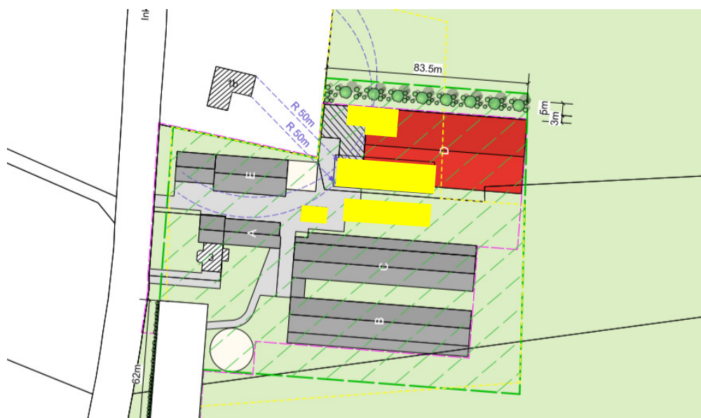
Figuur 3. Te verwijderen gebouwen (gele vlakken) en de nieuwbouw (rood vlak) De te amoveren bomenrij bevindt zich tussen de bovenste twee gebouwen. (Bron ondergrond: Agra-Matic B.V.)
