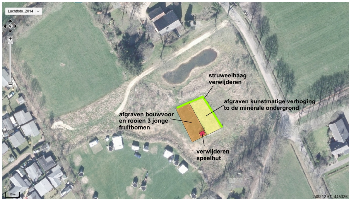
Figuur 5. Te verwijderen onderdelen en grondwerk locatie 1.
