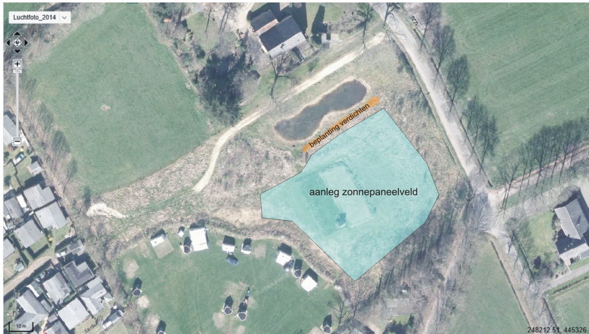
Figuur 4. Inrichtingsplan zonnepaneelveld locatie 1.
