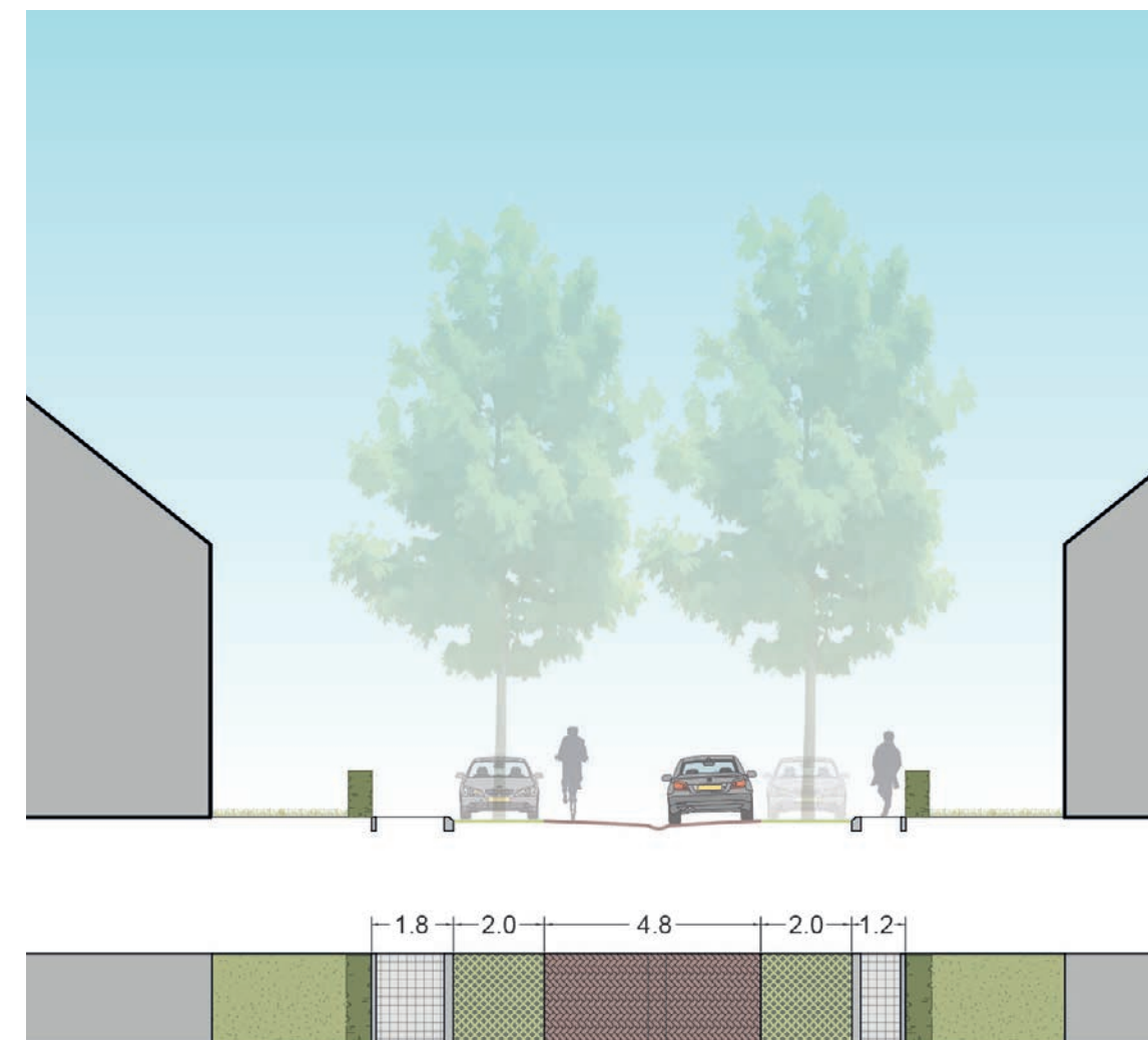
Straatprofiel van de secundaire ontsluiting, met materialen
