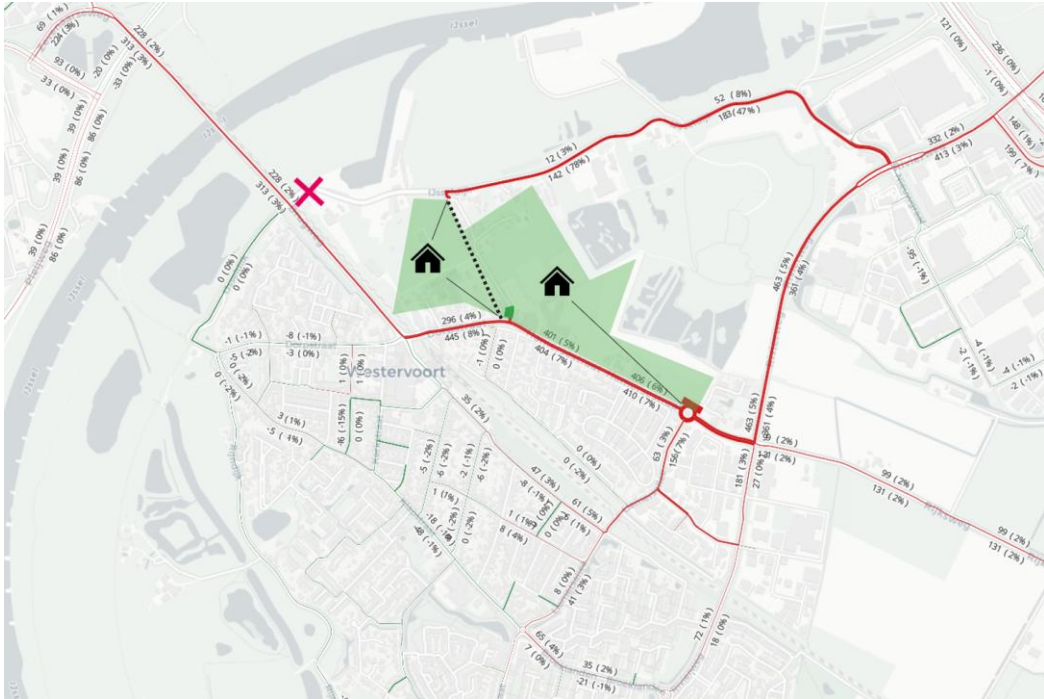
Figuur 3.2: De toename (rode lijnen) en afname (groene lijnen) in gemotoriseerd verkeer door het ontwikkelen van Westervoort-Noord en het toevoegen van een zachte knip op de Brouwerslaan in 2034
