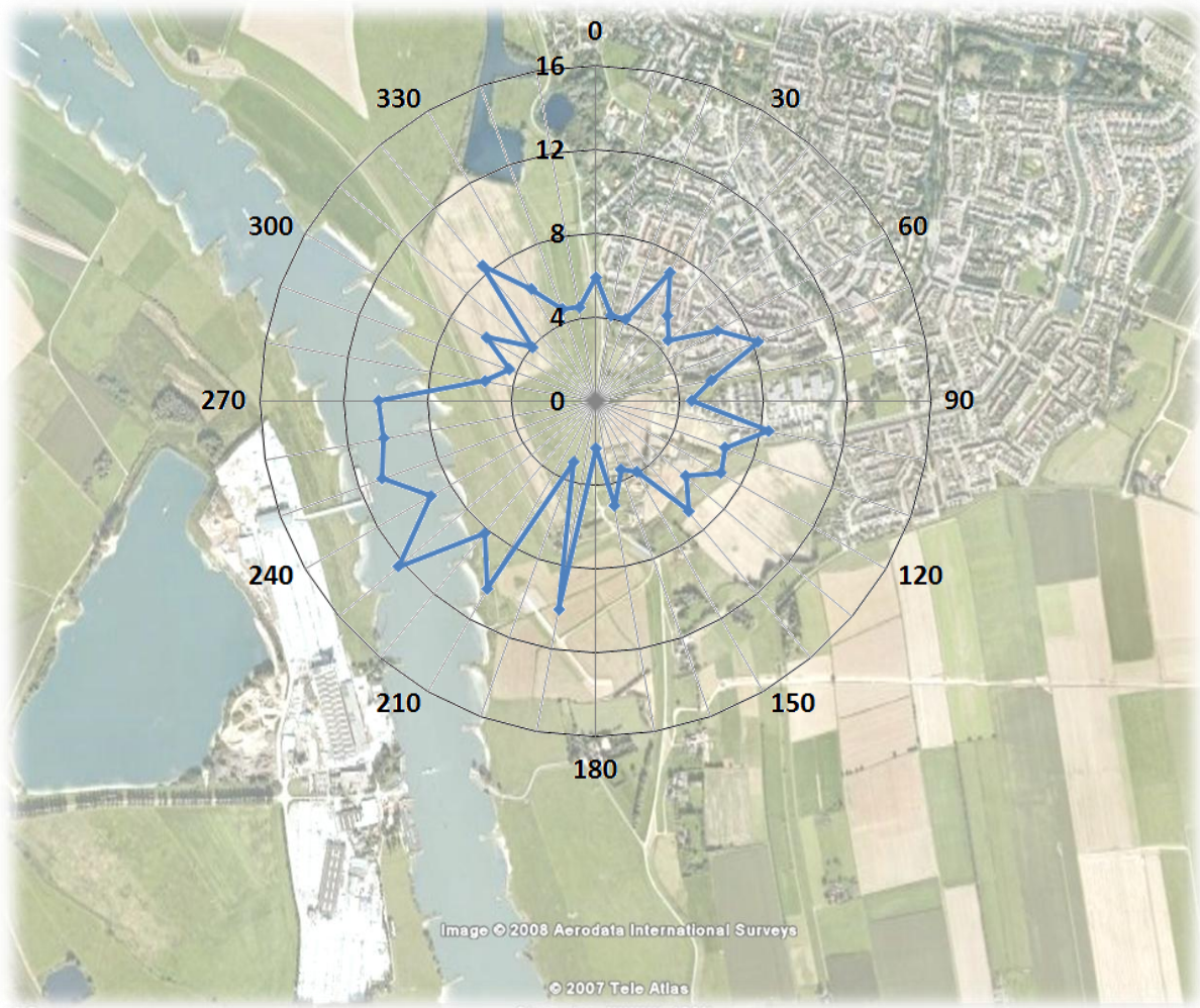
Figuur 3. Grofstofconcentratie in \mu\text{g}/\text{m}^3 onderverdeeld in windrichtingssectoren van 10^\circ . (Bron van de achtergrond: Google Earth)
