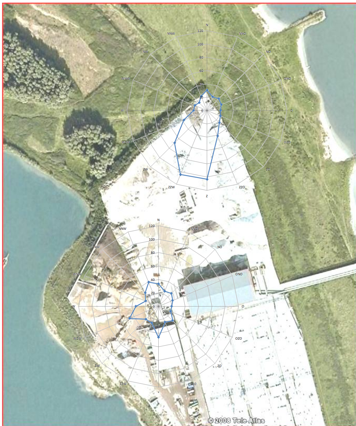
Figuur 5. Meetresultaten PM10 concentratiemetingen rond Van Dalen, in de vorm van concentratierozen
