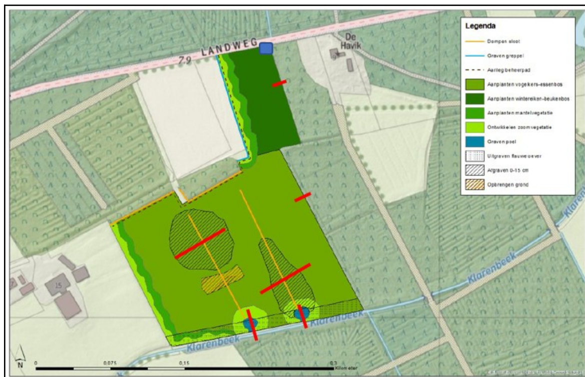
Afbeelding 6. Ontwerp inclusief werkzaamheden perceel oost (Bron: Opdrachtgever).
