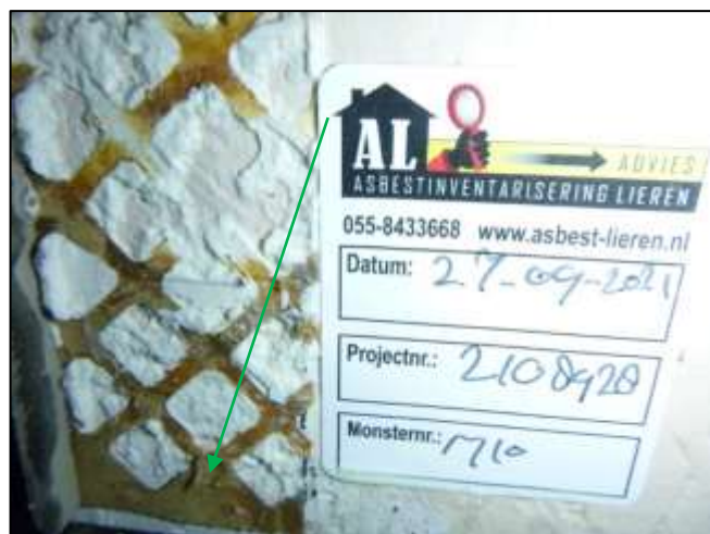
Foto 96: Keuken, wanden: Tegellijm (Bron 10) (Niet asbesthoudend)
