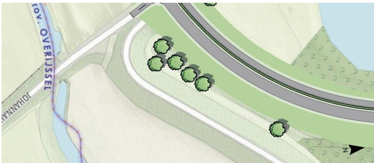
Figuur 8 Splitsing in dijk en het verschil tussen de oude en nieuwe dijk zijn goed zichtbaar door de laagte tussen de twee dijken. Deze dient behouden te blijven.
