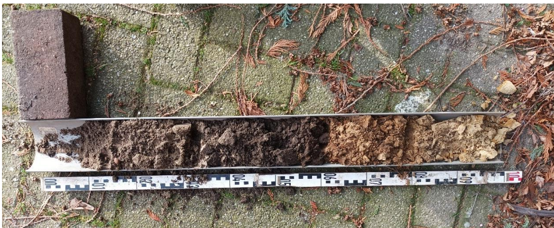
Afbeelding 17 Overzichtsfoto van boring 1 met v.l.n.r. de betonklinker, een ophooglaag, een vergraven B/C-horizont en het dekzand.
